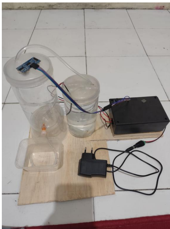
Gambar 2.2 Prototype Sistem Monitoring dan Kendali Ketinggian Air Tandon Berbasis IOT
